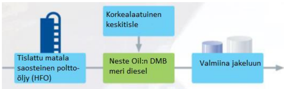
Kuva 6.10. Raskaan polttoöljyn (HFO) käsittely laivapolttoöljyksi (MDO-DMB) [Neste 2014]
